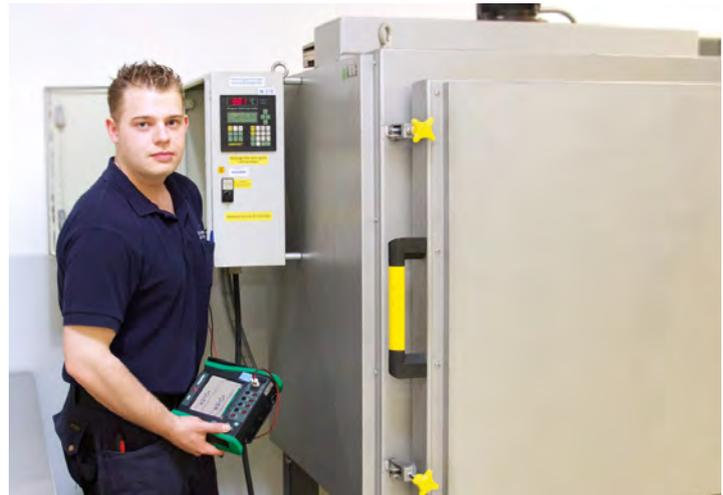
A Técnico de asistencia durante control/mantenimiento en instalaciones de un cliente (CQI-9 o AMS 2750 E)
