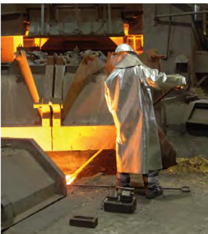
Medición de temperatura en elementos líquidos, p.ej. fundición de metales
