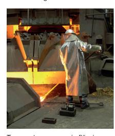
Temperaturmessung in flüssigen Metallen, z.B. in einem Stahlwerk
